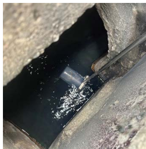
จุดที่ 3 บริเวณบ่อบำบัดน้ำสุดท้ายก่อนระบายออกจากโครงการ รูปที่ 3.2 จุดเก็บตัวอย่างคุณภาพน้ำทิ้ง
